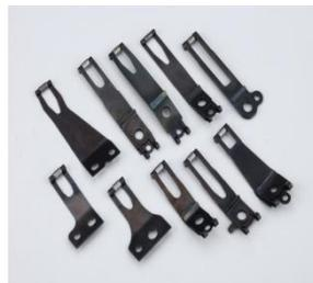
運転者が変速レバーをP、R、N、D段操作時に希望する位置に移動する時、変速感を感じさせ、その位置を離脱しないようにDETENT LEVER溝部位を押して固定する部品
