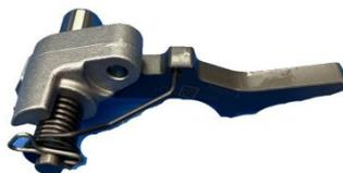
オートミッション車両の「P」段階を選択すると、パーキングスプラグをパーキングギアに置き換える。
